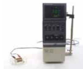
土壌抵抗率の測定 （ソイルボックス法（土壌箱法））
